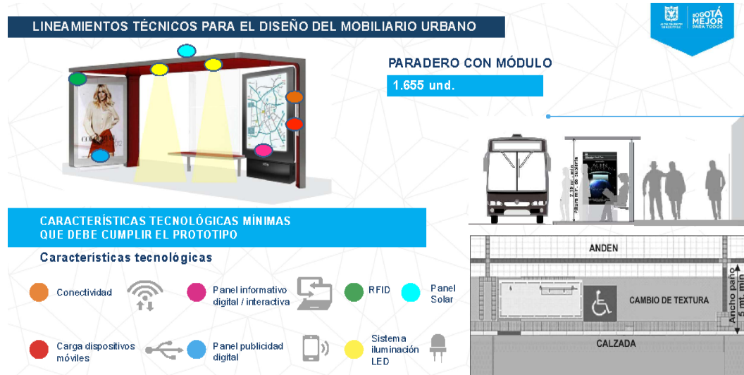
Gráfica 24. Lineamientos Técnicos para el Diseño de Paradero con Módulo
