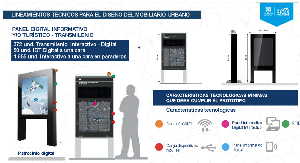
Gráfica 25. Lineamientos Técnicos para el Diseño de Paneles Digitales
